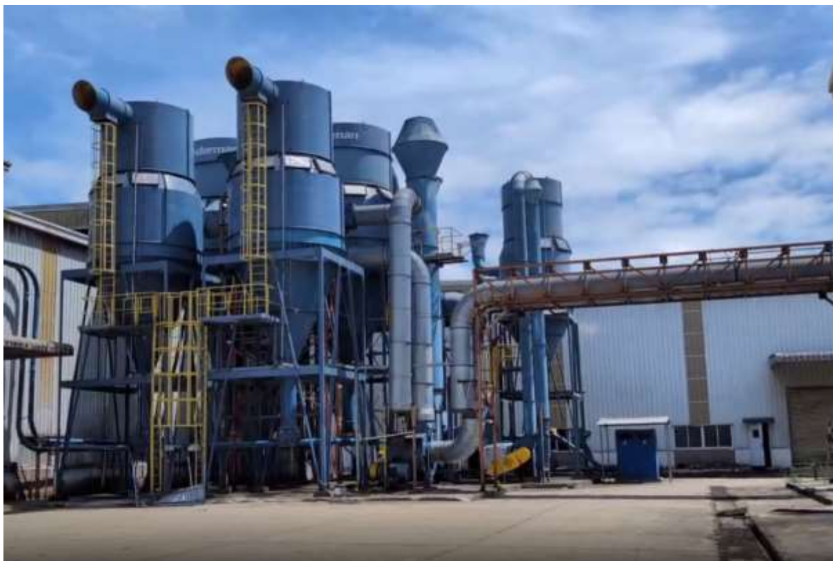
Hình 22. Hệ thống xử lý bụi của K4, K5
